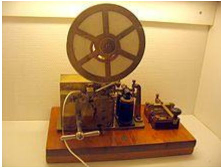
Figure 1 Télégraphe utilisé pour communiquer en Morse
