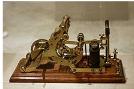
Figure 2 Premier récepteur automatique de signaux (1837)
