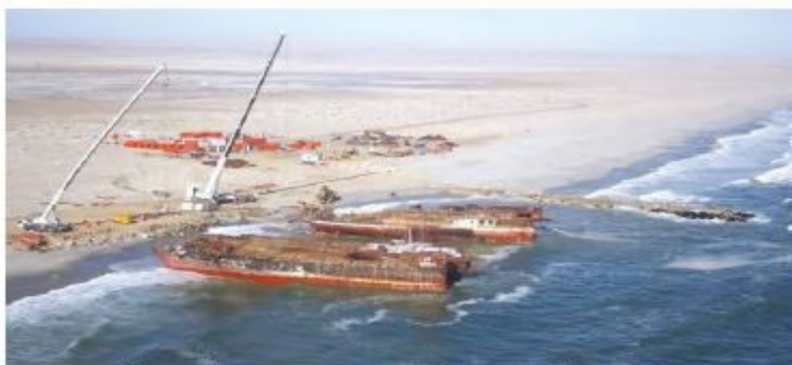
Avril 2013. le Chamarel a été scindé en deux parties pour faciliter son démontage ©Allgemeine Zeitung-Namibia
