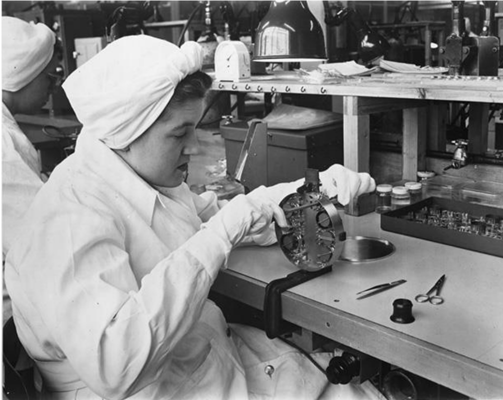
Techniciens construisant les répéteurs, 1955. Image de BT Heritage & Archives
